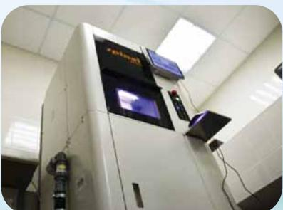
Фрезерный станок Spinell 5 x
